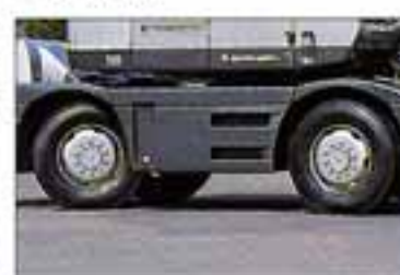
●後2輪操向最小回転半径(6.5m)
