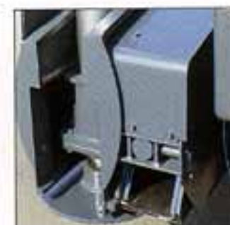
●アウトリガ張出し幅自動 検出装置
