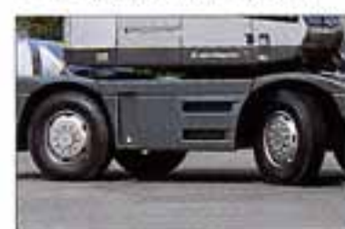
●前2輪操向最小回転半径(6.5m)
