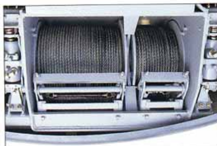
●スピーディで強力な2胴・2モータウインチ機構
