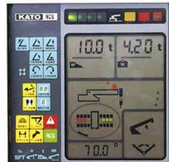
●アウトリガ張出幅自動検出装置と作業範囲制限機能付モーメントリミッタ
