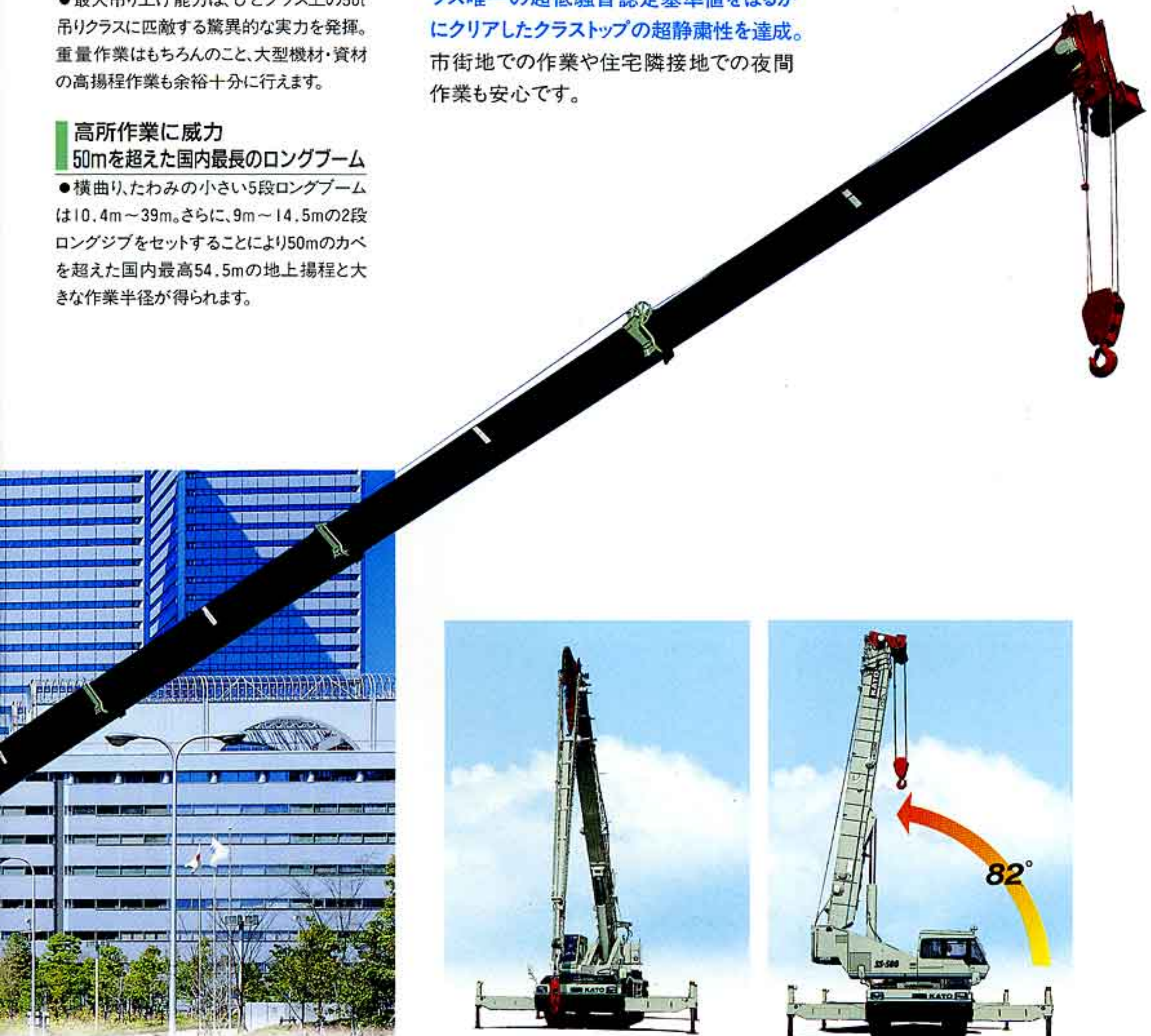
●狭い現場で短時間でセット、油圧式サイドアップジブ
