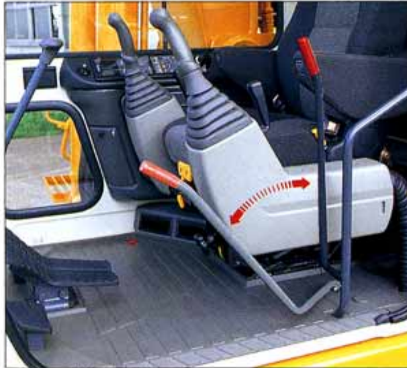
●不意の誤作動を未然に防止するセーフティロックレバー。
