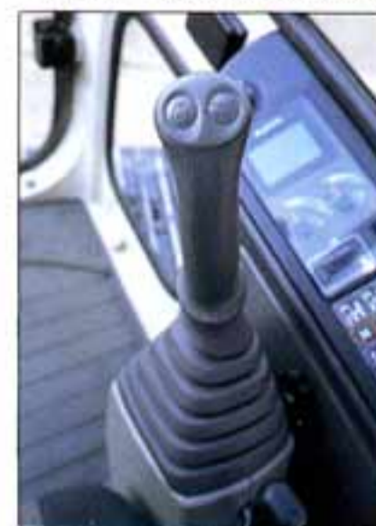
● オペレータの体格に合せたポジションが得られるレバー高さ・アームレスト角度調整機構。
