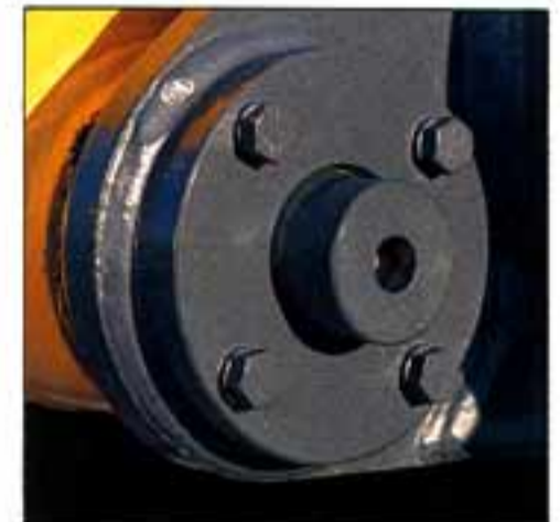
●バケットのガタを低減するクリアランス調整機構。
