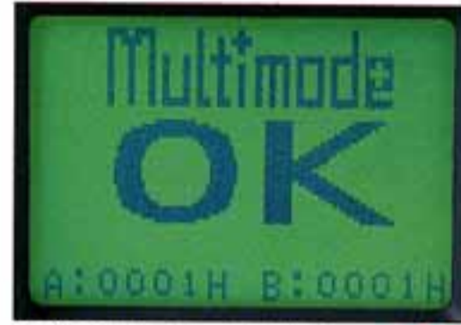
● 全てのモニターが正常で作動中に表示。 A, Bのサービスマータ表示
