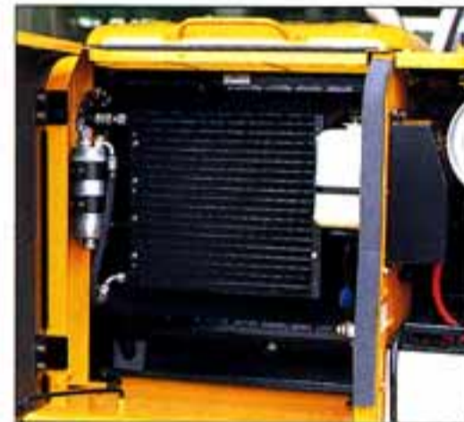
●ラジエータにはウェービングフィンを採用。目詰まりしにくい防塵ネットをも装備。(写真はエアコン装備車)
