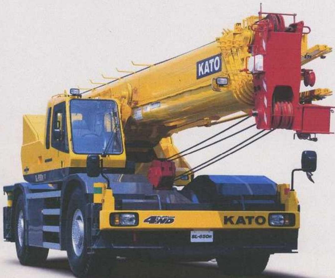
SL-650R(KR-65H)は、全装備（車検登録重量）で道路法による基本通行条件のD条件に適合しています。
