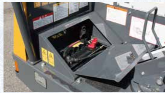
▲足置き兼バッテリーカバー バッテリーへのアクセスが良く、 カバーは足置きとして利用できます。
