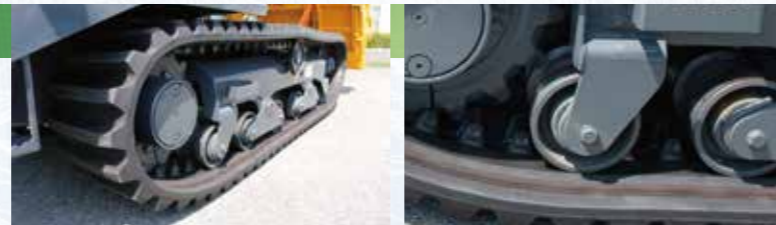
▲ラフな現場にも強いゴムクローラを採用 ▲走行安定度の高い固定ローラ
