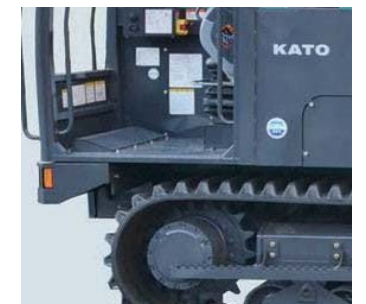
段差を無くして清掃しやすい構造
