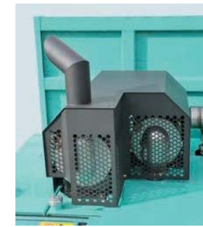
排ガス後処理装置
