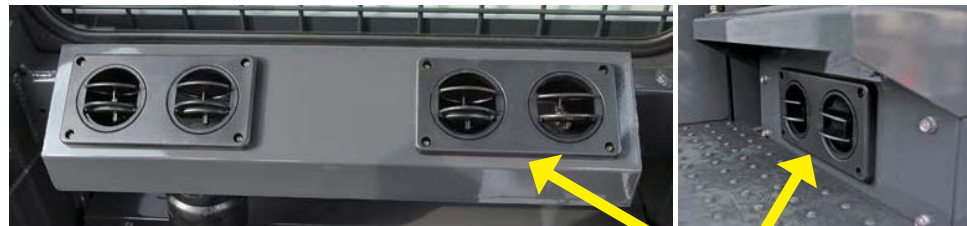
エアコンの排風口は座席後/座席下、足元の3箇所に設置し、足元部はデフロスタとして、活用可能です。
