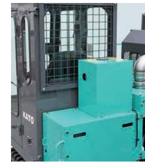
エンジン冷却水タンク
