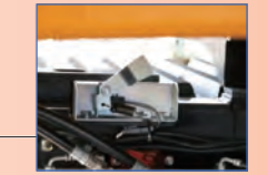
▲荷台浮き検知センサー
