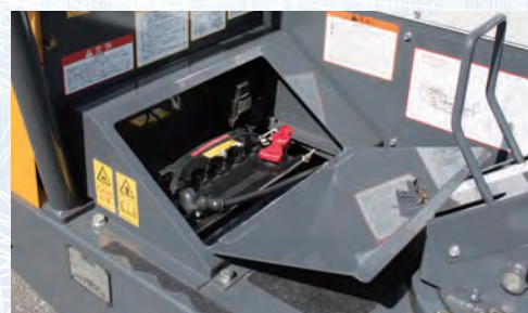
▲足置き兼バッテリーカバー バッテリーへのアクセスが良く、 カバーは足置きとして利用できます。
