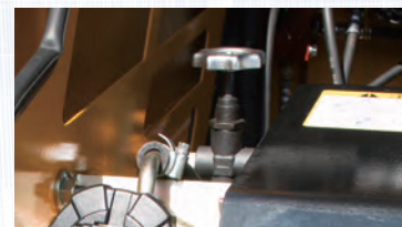
▲荷台緊急降下バルブ(エンジンルーム内) エンジントラブル時でも 安全に荷台を降下できます。
