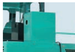
エンジン冷却水タンク
