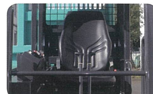
サスペンション付きハイバックシートを装着。疲れを軽減できます。
