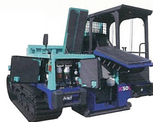
4箇所の開閉式カバーで点検、メンテナンス性を充実させました。
