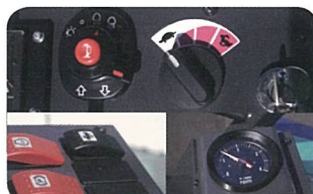
エンジンスロットルはダイヤル式を採用。大型タコメータを見やすい前方に配置しました。防水性の高いスイッチ類を採用し、信頼性の向上を図りました。
