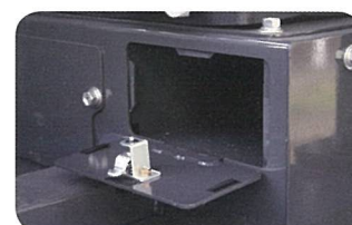
シートの下に小物などを収納できる工具入れを設けました。
