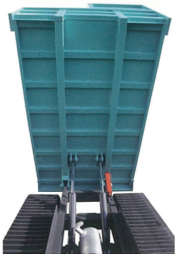
荷台裏に補強材を配置。厳しい作業に耐える、頑丈な造りになっています。
