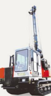
タワーヤーダは、切り倒した木を集めための移動可能な集材機械です。集材用のワインチとワイヤーロープを張るためのタワーを装備し、フォワーダなどの機械が入っていけないような急な山の斜面で活躍します。KATOのタワーヤーダは3ドラム型ランニングスカイライン方式により強力で安定した牽引力を発揮し一度に多くの材を搬出できます。
