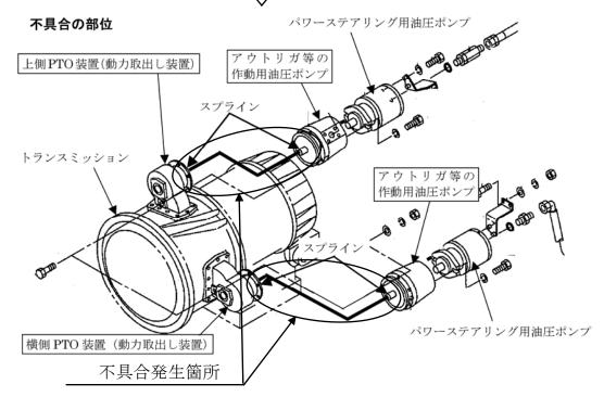
PTO装置(動力取り出し装置)とアウトリガ等の作動用油圧ポンプの接合部の防水構造が 不適切であり、また当該PTO装置からの動力を当該油圧ポンプへ伝えるスプラインに塗布 するグリース量が不足しているため、スプラインに錆が発生し、そのまま使用を続けると、 当該スプラインが摩滅するものがある。そのため、当該油圧ポンプ及びパワーステアリング 用油圧ポンプが作動しなくなり、アウトリガの作動及びサスペンションのオイル量の調整が できなくなるとともに、トランスミッション用オイルの冷却ファンが作動せず、オイルの温 度が上昇して警告灯が点灯するおそれがあり、また、ハンドル操作力が増大するおそれがあ る。
