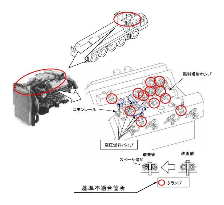
燃料噴射装置の高圧燃料パイプを締付けるクランプの構造が不適切なため、エンジン振動によりクランプボルトが緩み、当該クランプが脱落することがある。
