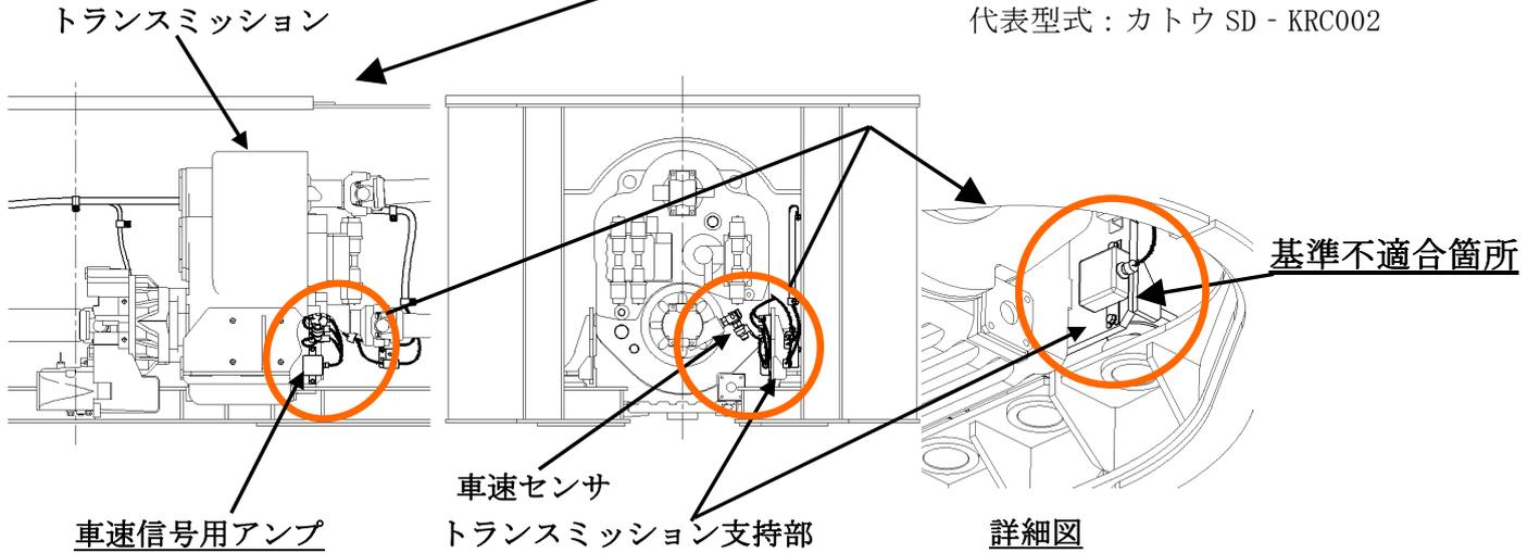
速度計において、車速信号用アンプの取り付け位置が不適切なため、当該アンプがトランスミッション等からの強い振動を受ける場合がある。そのため、そのままの状態で使用を続けると、当該アンプの内部素子が破損し、正常な速度表示が出来なくなるおそれがある。
