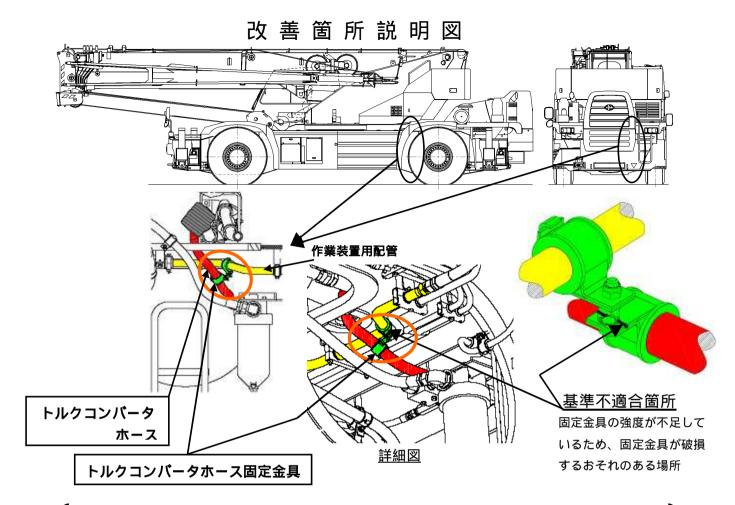
リコール届出番号「2024」の改善措置において、追加したトルクコンバータホースの固定金具の強度が不足しているため、当該固定金具が破損する場合がある。そのため、そのまま使用を続けると、トルクコンバータホースが作業装置用配管と接触、摩耗し、最悪の場合オイルが漏れ、走行不能になるおそれがある。
