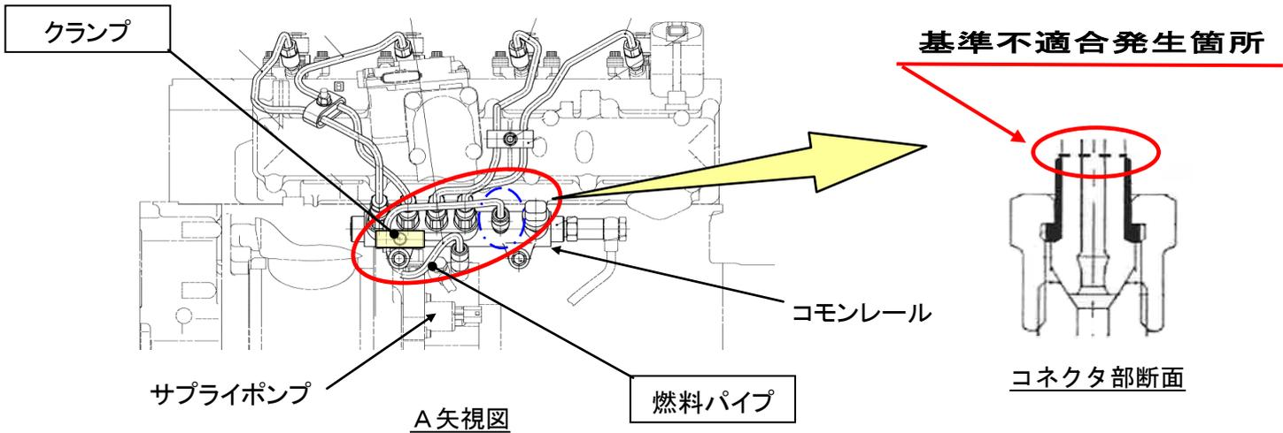
原動機において、サプライポンプとコモンレール間の燃料パイプを固定するクランプを付け忘れたものがある。そのため、エンジンの振動によりパイプに亀裂が発生し、燃料が漏れるおそれがある。
