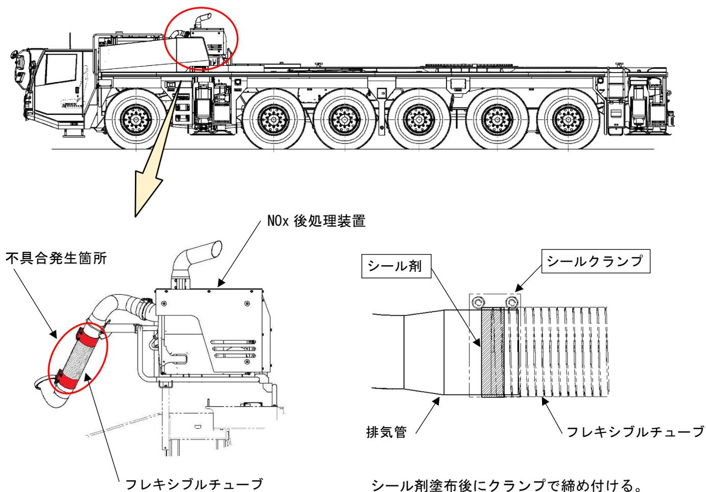
シール剤塗布後にクランプで締め付ける。
