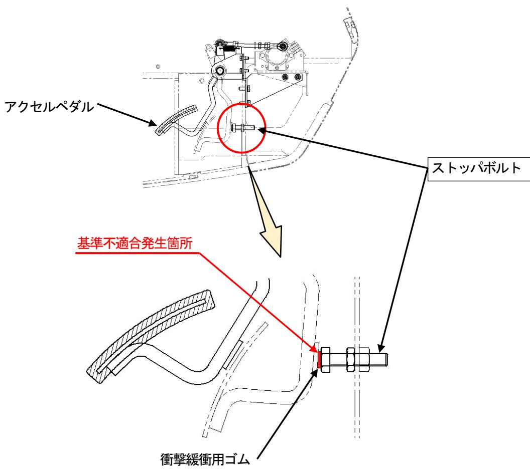
ストップボルト先端ゴムにアクセルペダルが貼り付く。
